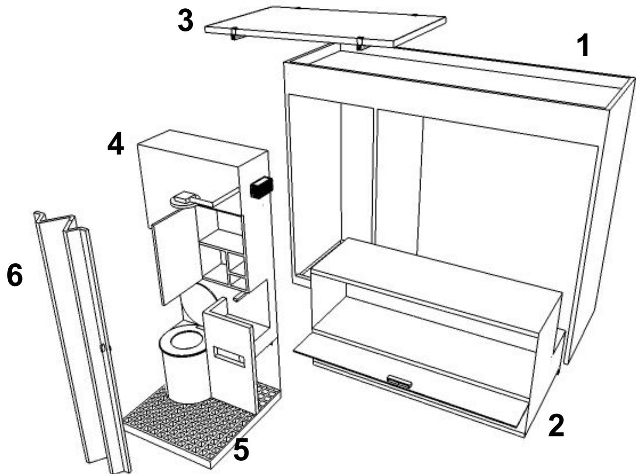
1 - Fechamento do ponto de ônibus em sistema steel frame com vedação em OSB e revestimento em alumínio composto cor cinza
