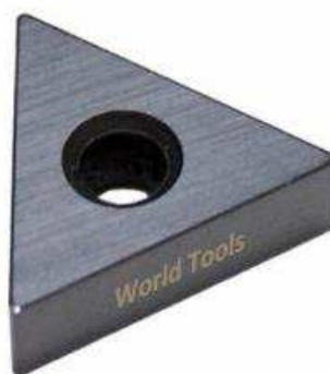
Figura 3.13 – Inserto de Cerâmica (Fonte: World Tools, 2019).
