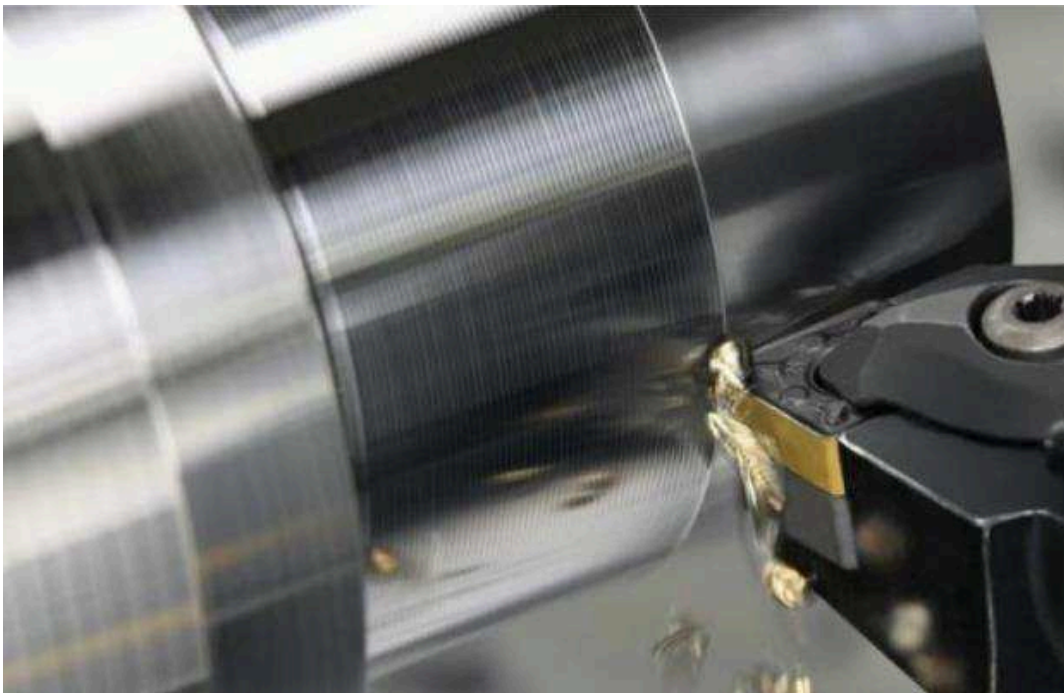
Figura 3.9 – Processo de Torneamento (Fonte: Fermecc, 2019).
