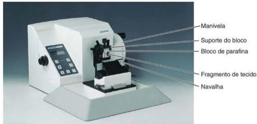
Figura 3 – Micrótomo para cortar tecidos incluídos em parafina. Acionando-se a manivela (à direita da figura), o bloco contendo o fragmento de tecido sobe e desce. Após cada volta da manivela, o bloco avança uma distância definida (geralmente 1 a 10  $\mu\text{m}$ ) e, ao passar pela navalha, deixa uma fatia do tecido (JUNQUEIRA; CARNEIRO, 2013).
