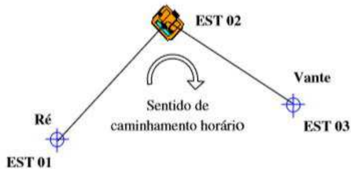
Figura 14 - Estação ré e vante.
