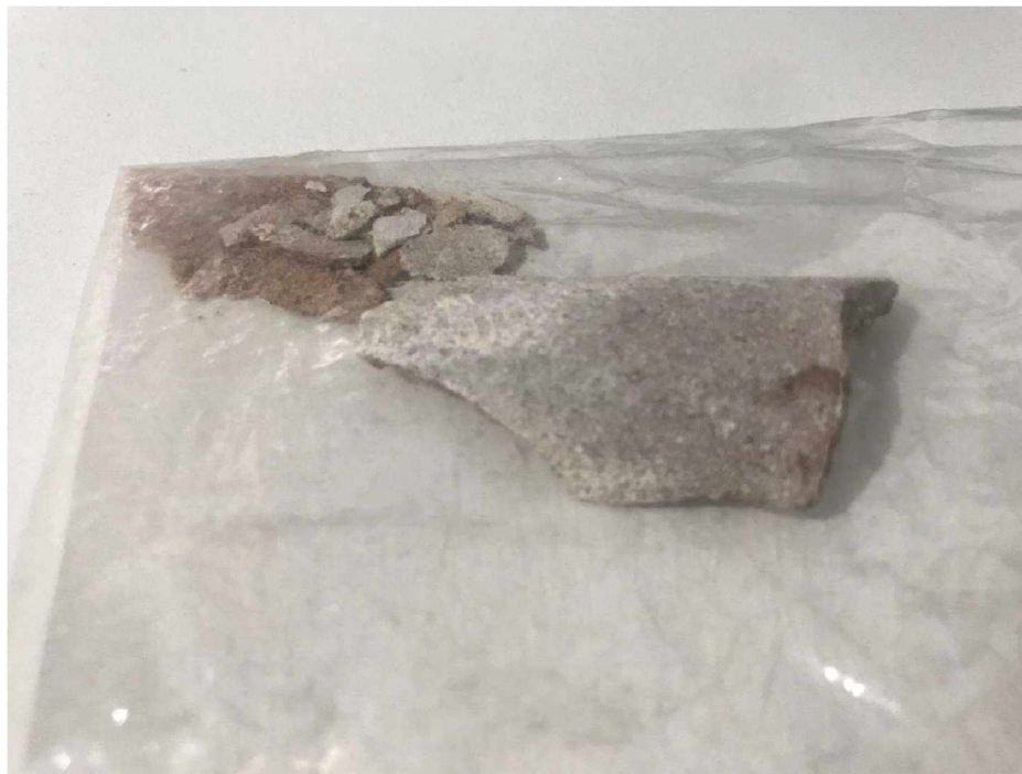
Figura 90 - Teste de esmagamento da argamassa de revestimento Palácio dos Leões
