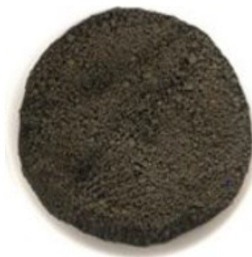
Figura 3.7 - Cascalho contaminado com fluido de perfuração a 12,5 % em massa de olefina (MOTA, 2018).
