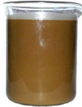
Figura 3.1 - Fluido de perfuração utilizado nos ensaios experimentais. Fonte: adaptado de Mota (2018).
