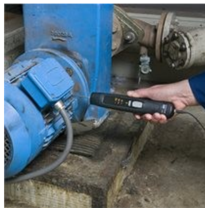
Figura 1: Estetoscópio eletrônico para avaliação de rolamentos da empresa.
