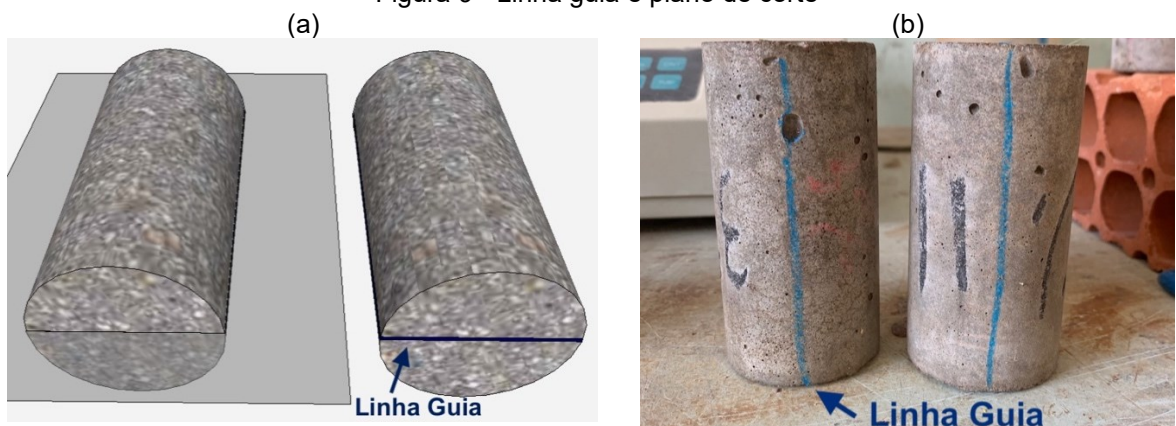
Figura 9 - Linha guia e plano de corte
