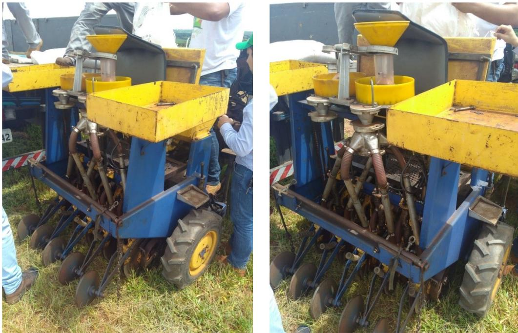
**Figura 4.** Detalhes da semeadora de parcelas Semina II, no momento da semeadura do trigo.
