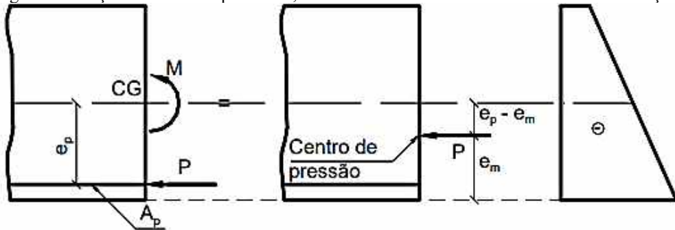
Figura 11 - Seção submetida à protensão, momento fletor externo e excentricidades da força P.
