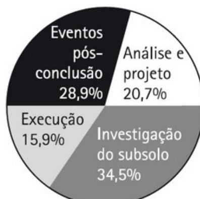
Figura 6- Origem dos problemas em fundações no Rio Grande do Sul.
