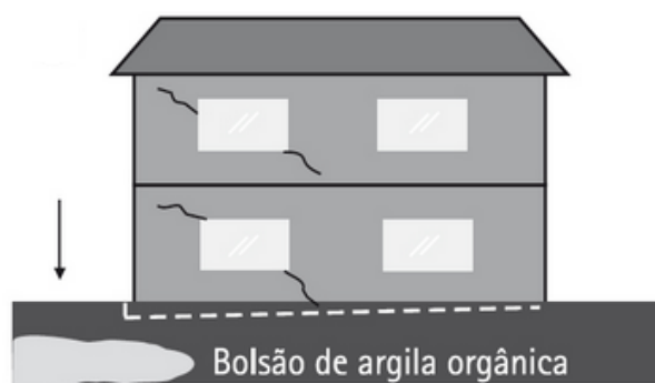
Figura 10- Problema com a adoção de projeto com perfil de solo inadequado.
