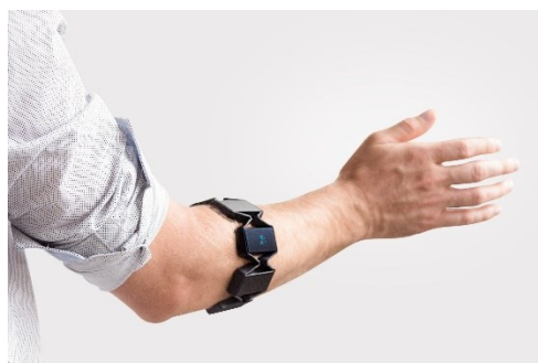
Figura 7: Bracelete Myo no antebraço de um sujeito.
