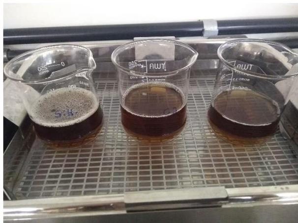
Figura 2 – Desgaseificação das amostras de cerveja em banho ultrassônico (Autor próprio).
