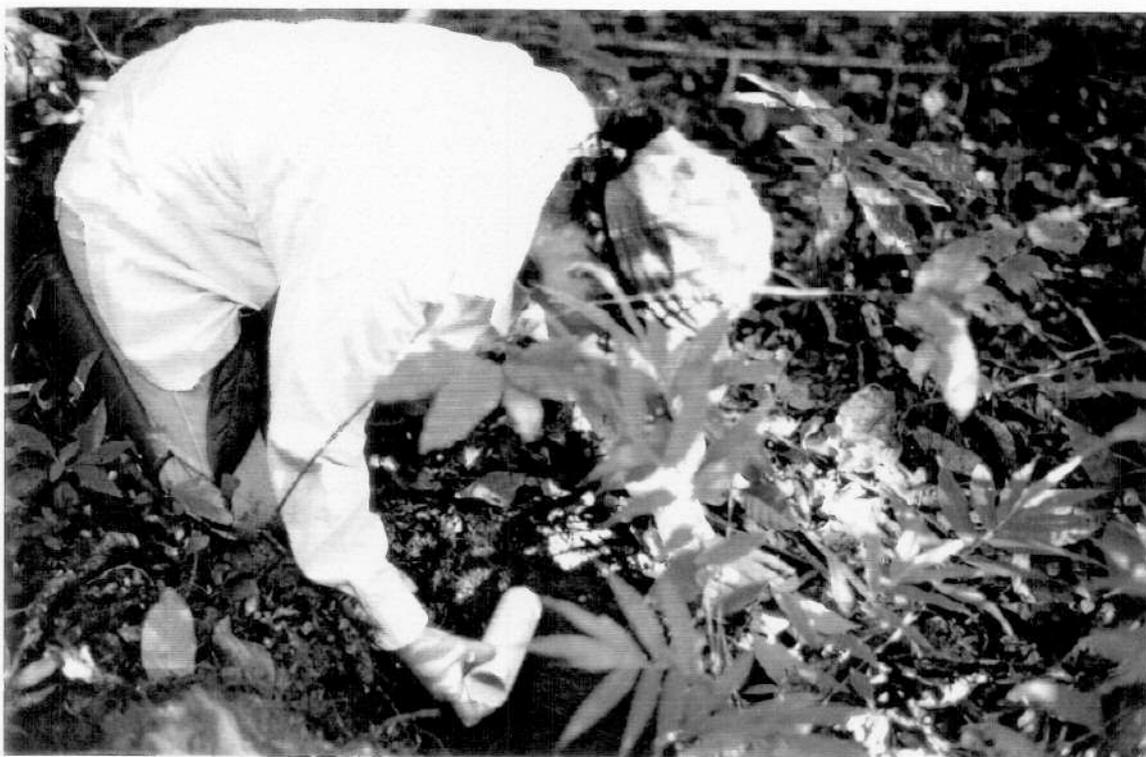
Figura 2 – Coleta das amostras de solo utilizando um tubo de P.V. C de 5 cm de diâmetro, paralelamente em relação à superfície, na mata de galeria da Estação Ecológica do Panga, Uberlândia – MG.
