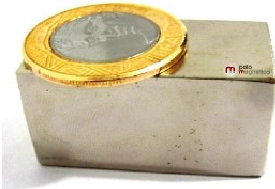
Figura 3.2 – Ímã de neodímio 40x20x20. Fonte: polomagnético.com.br
