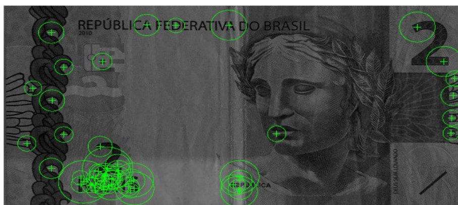
Figura 29: Pontos de interesse extraídos em uma cédula de dois reais, usando algoritmo SURF.
