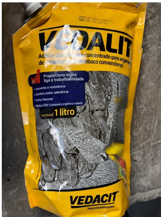
Figura 5 – Aditivo utilizado no lugar da cal hidratada.
