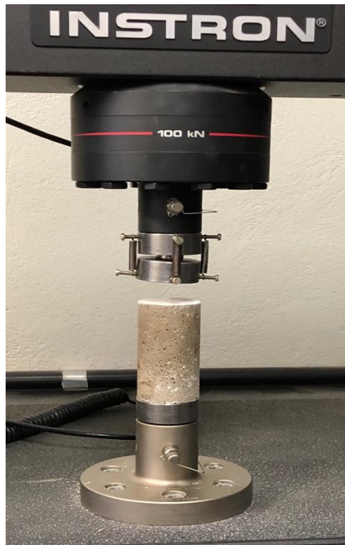
Figura 11 - Ensaio de resistência à compressão.
