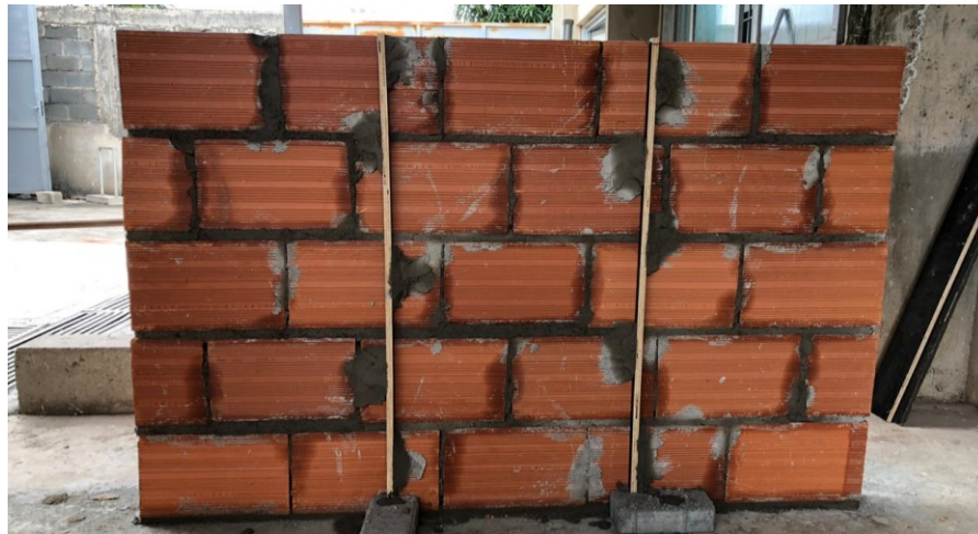
Figura 8 - Face B sem chapisco.
