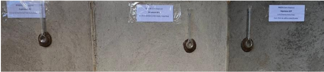
Figura 21 – Fixação dos cachimbos em cada painel de argamassa.
