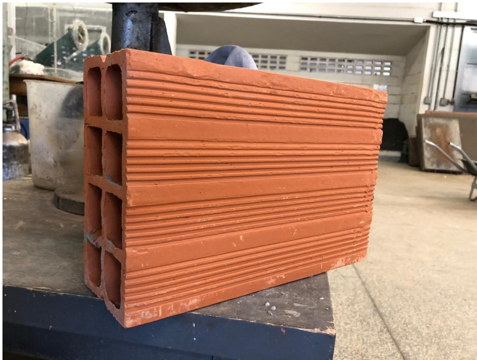
Figura 6 – Bloco cerâmico utilizado para montagem do painel.
