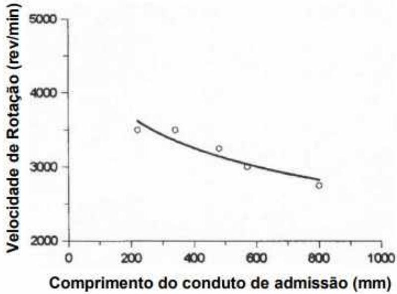
Figura 10: Torque máximo calculado em função do comprimento do conduto de admissão (Nowakowski e Sobieszczanski, 1999).
