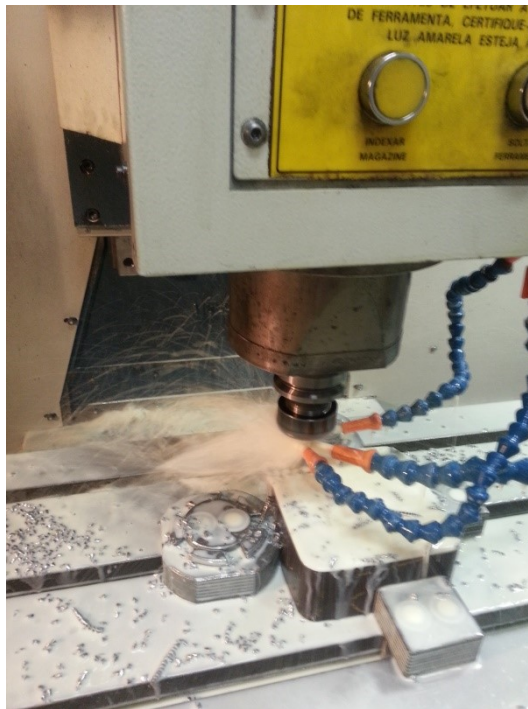
Figura 3.81 – Furação com aplicação fluido ME-1 forma de jorro.
