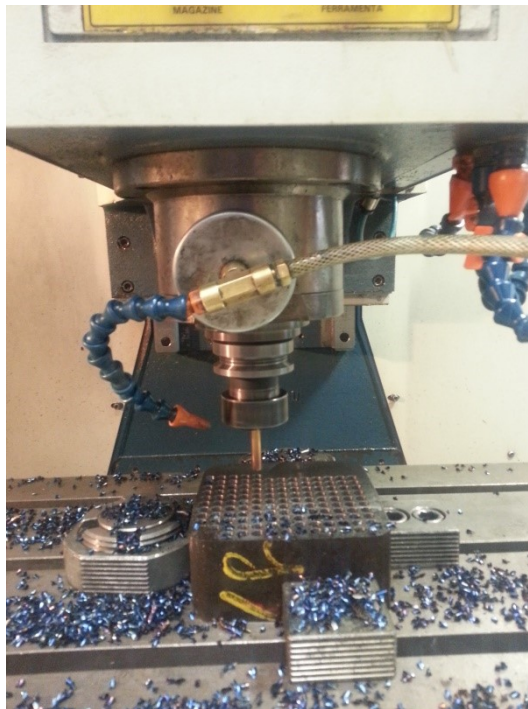
Figura 3.103 – Fluido Blasocut 40 NF forma de MQL.
