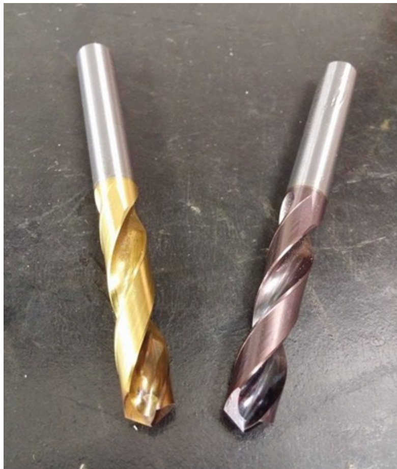
Figura 3. 3 – Brocas utilizadas no projeto lado esquerdo a revestida com TiN e direito TiAlN.
