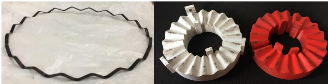
Figura 3.4 – a) Mola circular para anéis e b) matriz de conformação das molas para os anéis.
