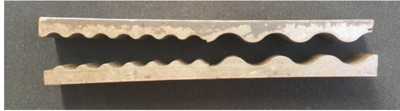
Figura 3.5 – Matriz de conformação das molas lineares dos selos do pistão.
