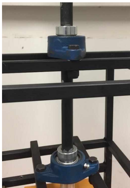
Figura A-6 – Montagem do eixo sobre os rolamentos e mancais.
