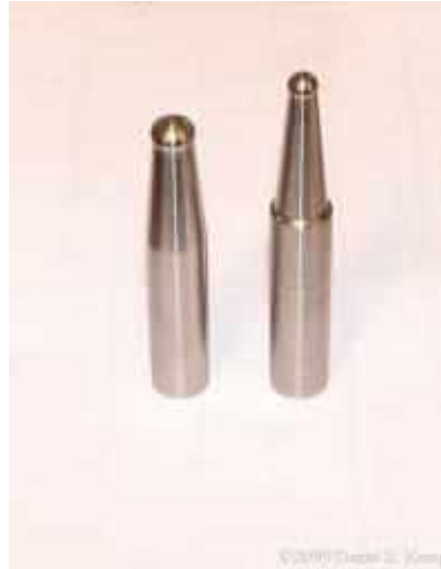
Figura 2-15 - Exemplo de ferramentas de ponta semiesférica utilizadas no processo de EI
