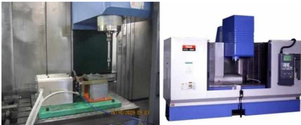
Figura 2-12 - Máquina CNC MAZAK VTC-300C três eixos utilizada na estampagem incremental de chapas de metal. (SY, 2009)
