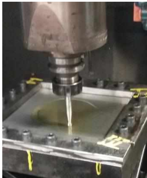
Figura 2-11 - Processo de EI acontecendo com óleo SAE 80W como lubrificante
