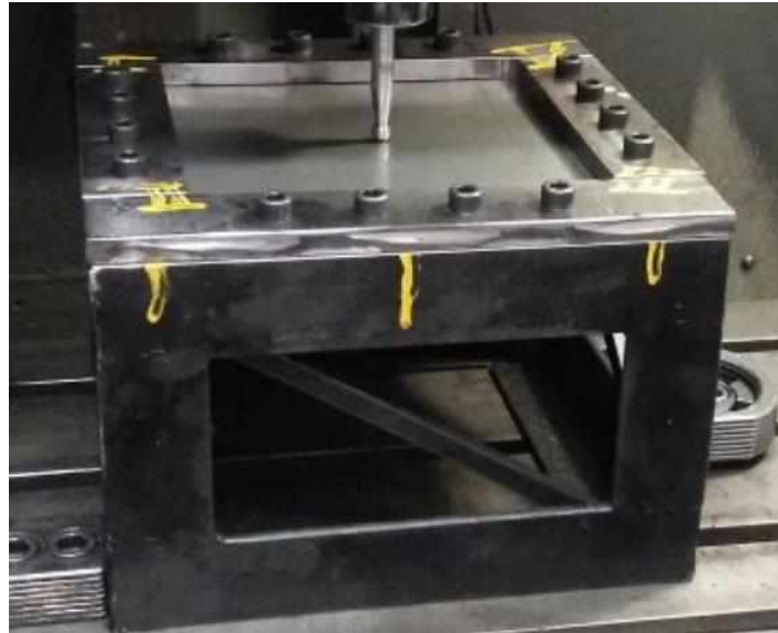
Figura 3-4 - Dispositivo prensa-chapas fixando uma chapa durante o processo de EI
