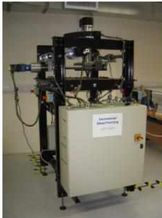
Figura 2-13 - Máquina própria para o processo de estampagem incremental (JACKSON et al. 2008)
