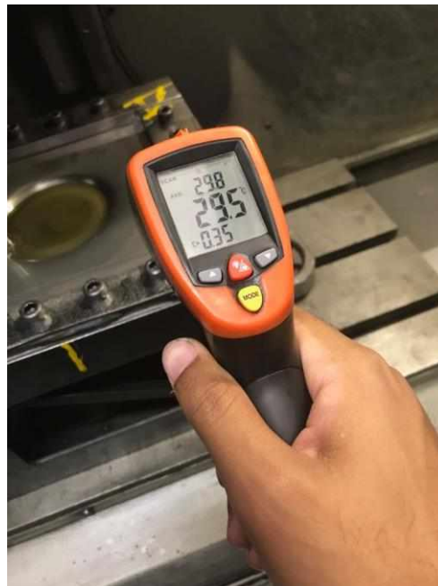
Figura 3-7 - Termômetro de infravermelho utilizado na medição de temperatura do processo
