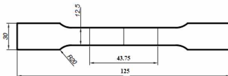
Figura 3-10 - Dimensões dos corpos de prova utilizados no ensaio de tração
