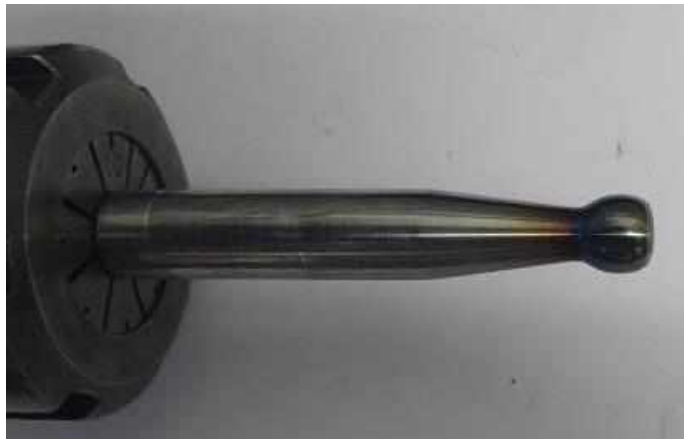
Figura 3-2 - Ferramenta de AISI 52100 utilizada nos testes de EI
