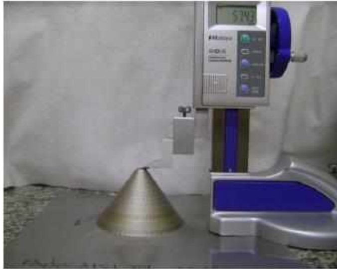
Figura 3-15 - Medição da profundidade da peça após o processo de estampagem incremental
