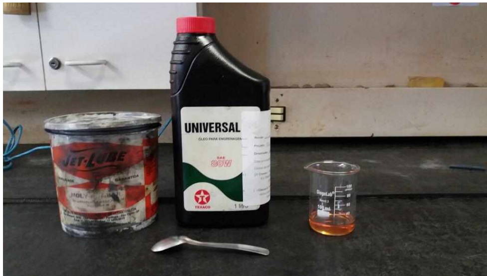
Figura 3-8 - Óleo 80W e grafite em pó utilizado para a lubrificação nos ensaios
