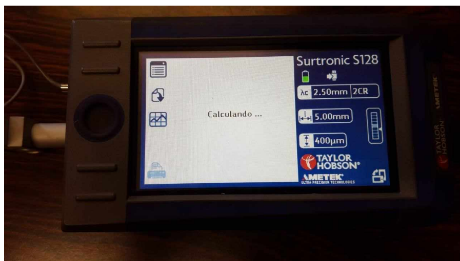
Figura 3-14 - Rugosímetro utilizado para a medição da rugosidade nas chapas
