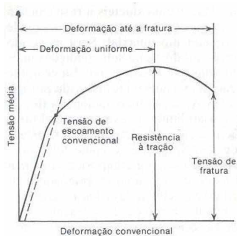
Figura 2-22 - Diagrama tensão em função da deformação obtido em um ensaio de tração (DIETER,1981)
