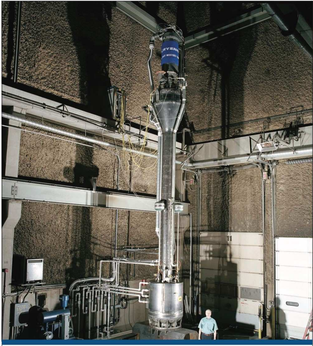
Figure 18: Fotografia do dispositivo de liquefação de gás (Fonte: SWIFT, 1997)
