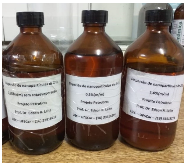
Figura 3.2 - Amostras dos nanofluidos de ZrO_2/OT , nas concentrações mássicas de 0,1; 0,5 e 1,0%, da esquerda para a direita.
