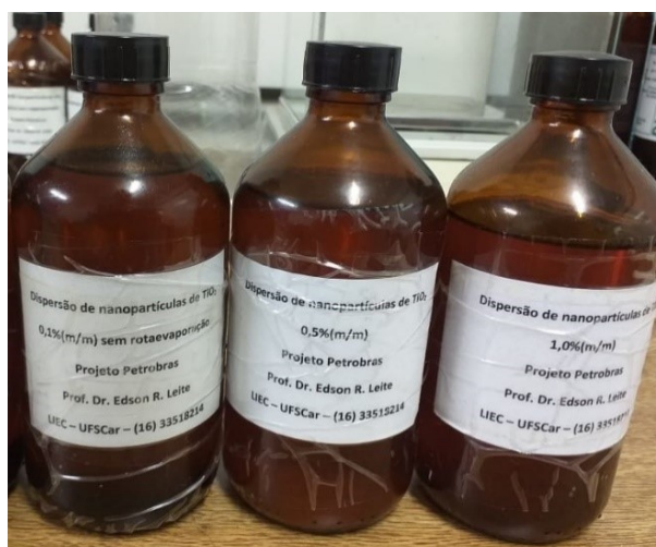
Figura 3.1 – Amostras dos nanofluidos de TiO 2 /OT, nas concentrações mássicas de 0,1; 0,5 e 1,0%, da esquerda para a direita.
