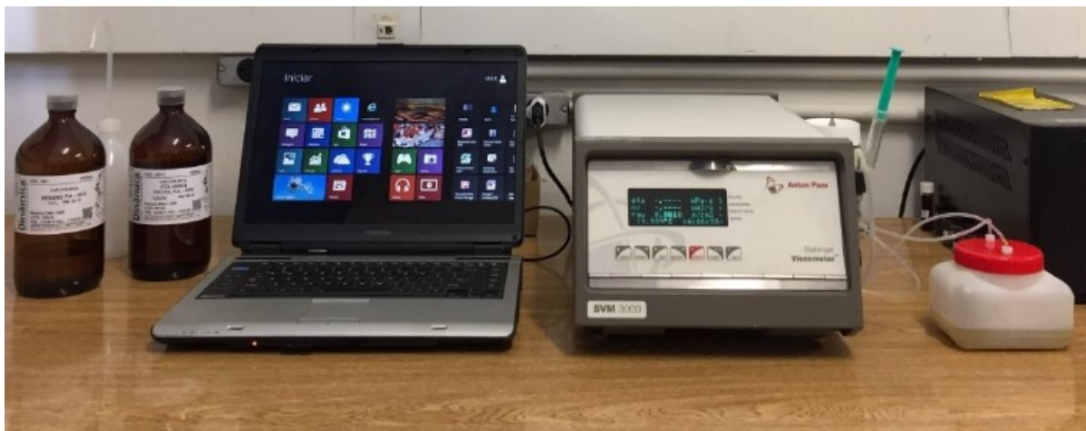
Figura 3.8 - Viscosímetro Stabinger SVM 3000/G2 utilizado para as medições de viscosidade dinâmica dos nanofluidos.
