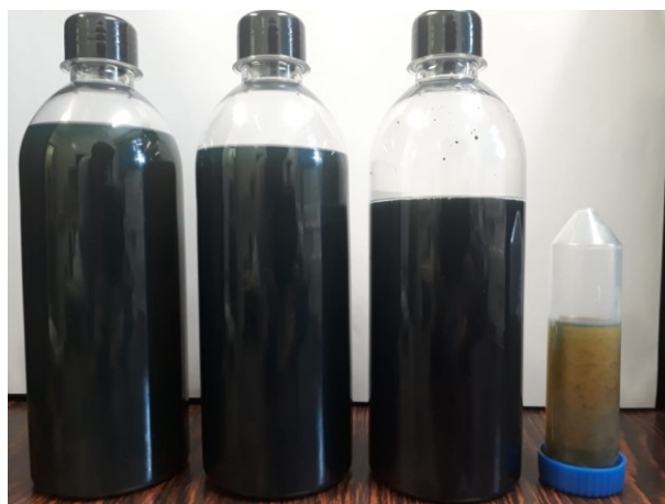
Figura 3.4 - Amostras dos nanofluidos de MWCNT/OT , nas concentrações mássicas de 0,01; 0,02; 0,12 e 0,12% após um mês, da esquerda para a direita.
