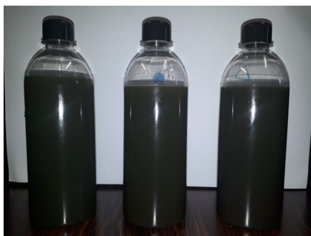
Figura 3.3 - Amostras dos nanofluidos de Ag/OT , nas concentrações mássicas de 0,06; 0,12 e 0,59%, da esquerda para a direita.
