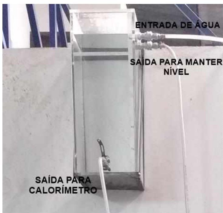
Figura 11. Reservatório de água utilizado para fornecer o fluxo de água do calorímetro.
