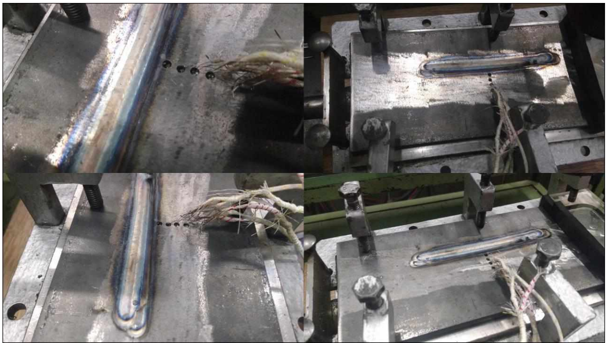
Figura 17. Termopar 0 danificado devido ao arco de soldagem.
