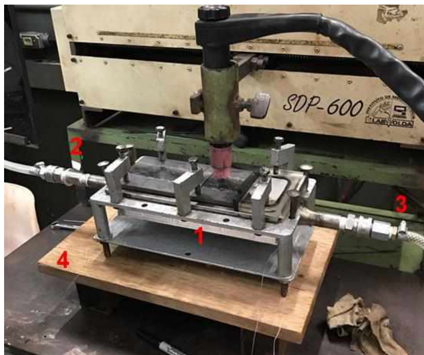
Figura 10. Foto do calorímetro utilizado. 1 – Calorímetro utilizado; 2 – Entrada de água vindo do reservatório; 3 – Saída de água; 4 – Suporte para manter a coluna d'água.
