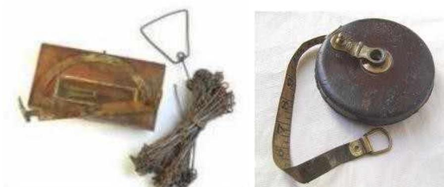
Figura 1 – Corrente do agrimensor, semi-transferidor e fita métrica. Fonte: GlobalGeo.
