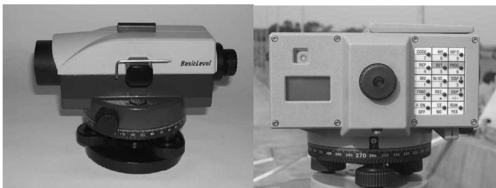
Figura 3 – Exemplos de Níveis: a) Nível óptico b) Nível digital. Fonte: (Faggion, 2011)
