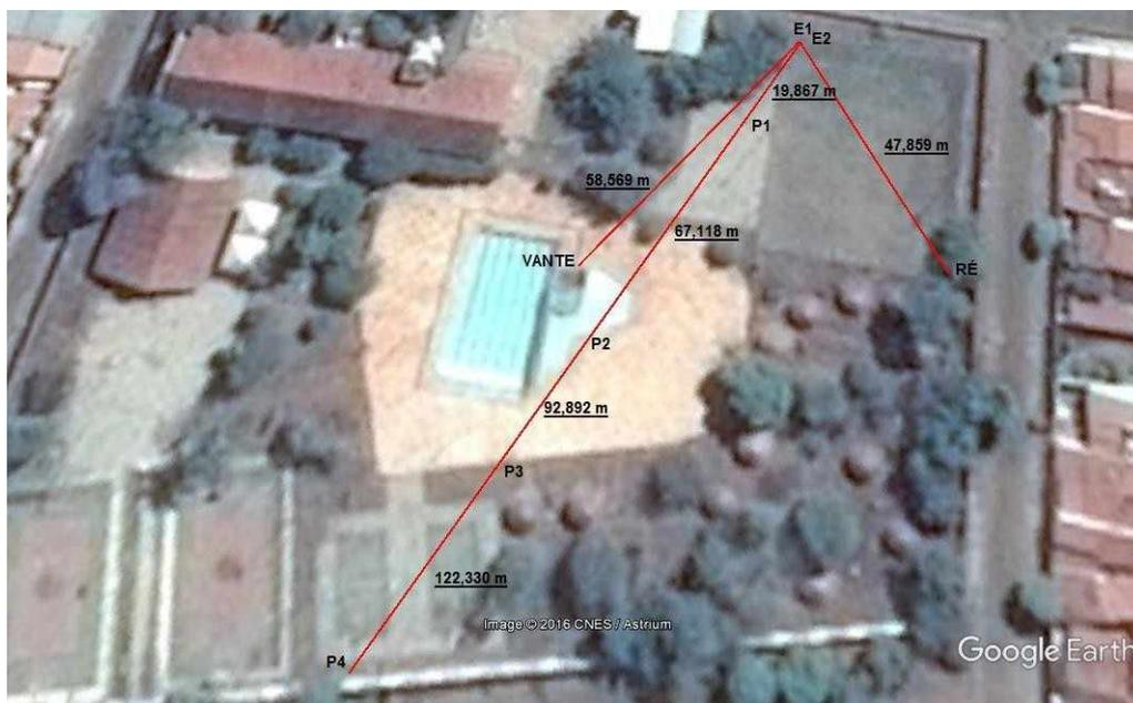
Figura 7 – Configuração dos pontos levantados em campo. Fonte: Google Earth.
