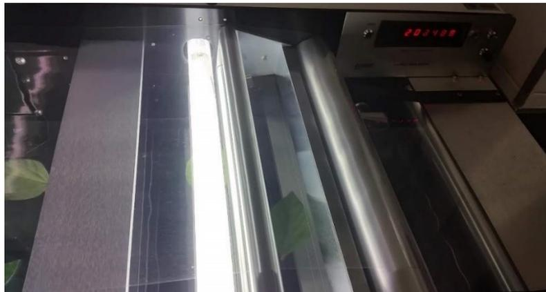
**FIGURA 5.** Escaneamento de folhas para obtenção de área foliar (LI-COR, modelo LI-3100C). Uberlândia – MG, 2019.
