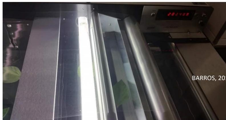
**FIGURA 2.** Escaneamento de folhas para obtenção de área foliar (LI-COR, modelo LI-3100C). Uberlândia – MG, 2019.
