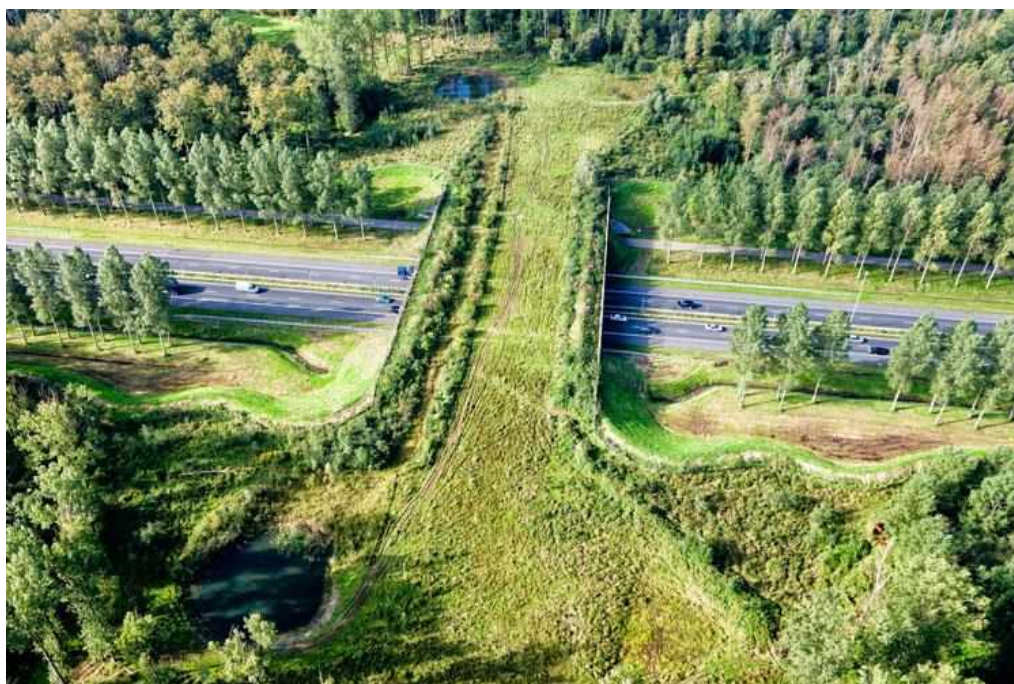
Figura 3 - Exemplo de ponte viva sobre rodovia
