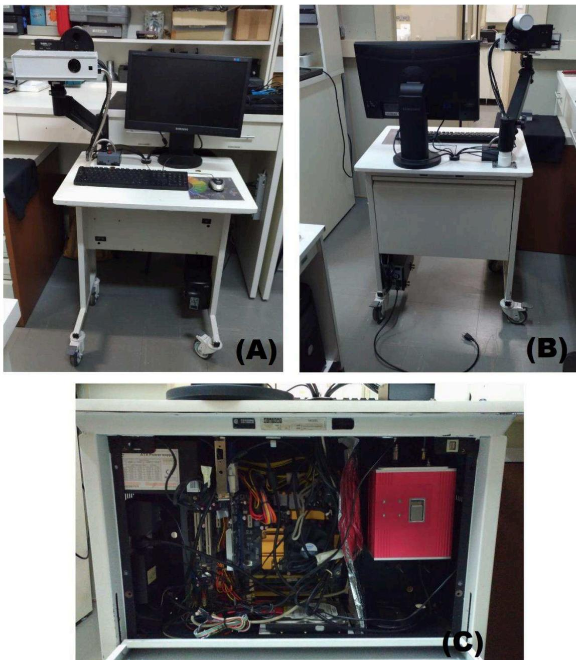
Figura 11: (A) Vista frontal e (B) Vista da parte traseira (fechada) da mesa onde está fixado o aparelho de SFDI para obter imagens médicas. Em (C) temos a região traseira contendo a parte eletrônica do equipamento.
