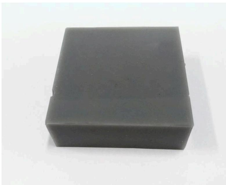
Figura 13: *Phantoms* de calibração do equipamento de *SFDI* contendo 5 mg de TiO<sub>2</sub>, 150 ml de PDMS e 70 mg de nankim.
