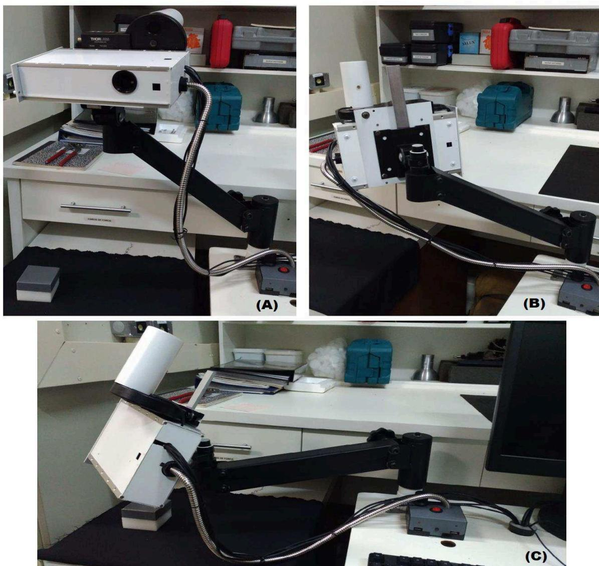
Figura 10: (A) Vista frontal e (B) Vista lateral do projetor e da câmera do SFDI, por fim, é mostrado em (C) a capacidade de mobilidade do braço acoplado à aparelhagem, onde foi fixado a um braço mecânico dobrável, visto que pretende-se fazer imagens funcionais.
