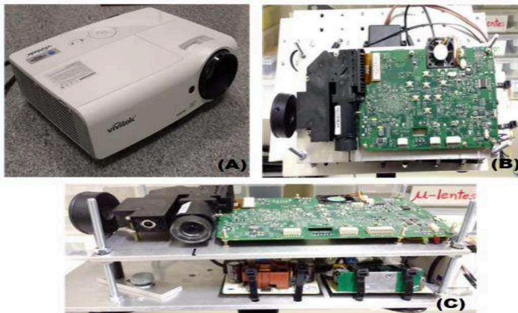
Figura 9: (A) Projeto Vivitek; (B) Vista superior do projetor desmontado e acoplado a estrutura do equipamento e (C) Vista frontal com os componentes ópticos e eletrônicos fixados a placa superior e inferior do projetor do SFDI.
