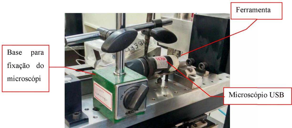
Figura 3.3.3 – Microscópio para referenciar ferramenta.
