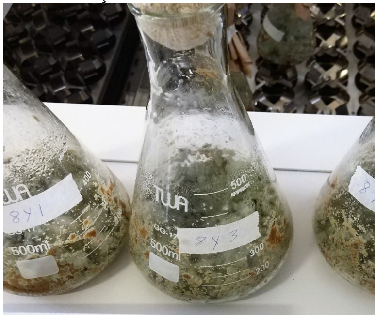
Figura 4.5 - Fermentação em estado sólido com o inóculo e substrato.
