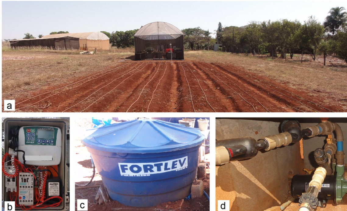
FIGURA 2.5 Principais equipamentos de irrigação utilizados: a) tubos gotejadores distribuídos na área de cultivo; b) conjunto de automação; c) reservatório de água, e; d) conjunto motobomba e filtragem.
