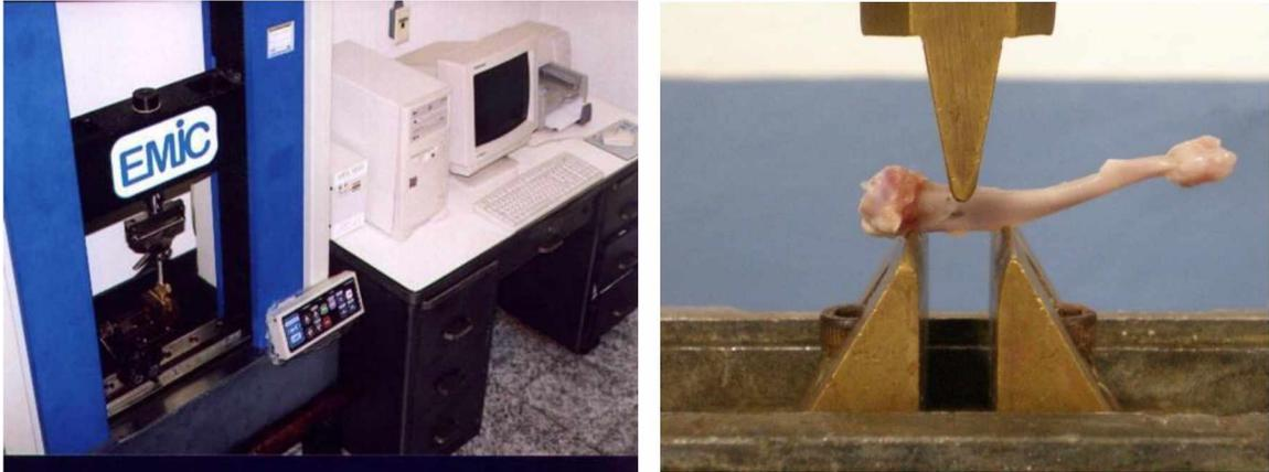
**FIGURA 3-** Máquina de ensaio e detalhamento da posição da tíbia.
