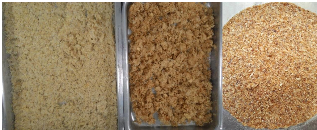
Figura 9: Pré-tratamento físico da biomassa.
