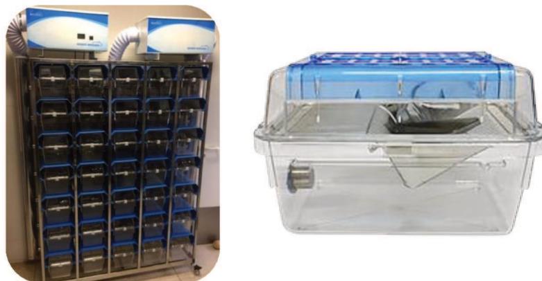
Figura 02 e 03 - Ilustração do modelo de estante e caixas mini isoladoras utilizadas para manter os camundongos em isolamento e proteção ao ar ambiente.
