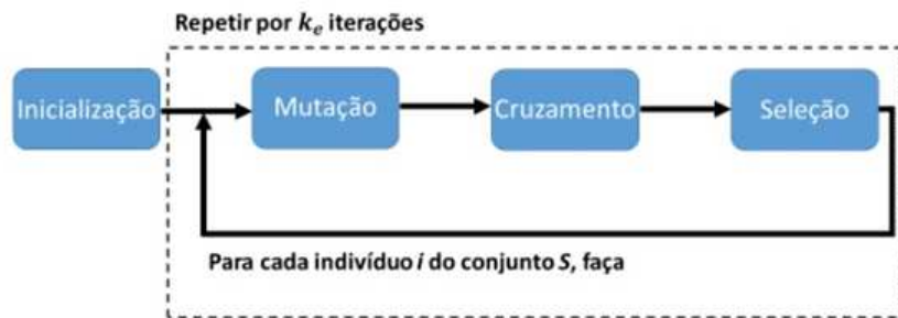
Figura 12: Representação da evolução diferencial, adaptada de Mór et al. (2015).
