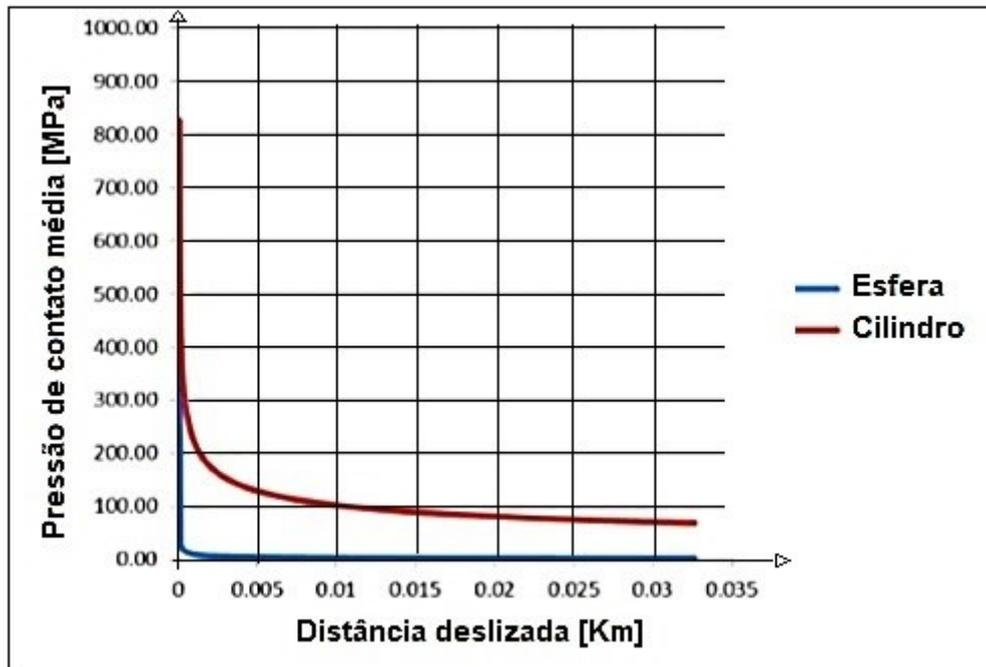
Figura 2.8 - Pressão de contato em função da distância deslizada para o contato esfera-plano e cilindro plano. Carga normal: esfera = 2 N, cilindro = 545 N. Pressão de contato inicial: 820MPa para ambos. (Phoenix Tribology Ltd - adaptado).
