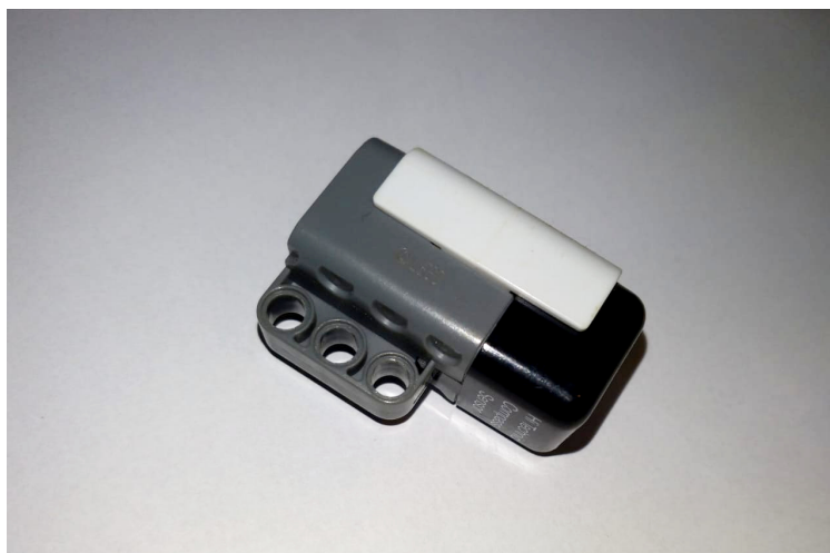
Figura 3.2 – Bússola eletrônica compatível com o kit NXT. Produzida pela HiTechnic®.
