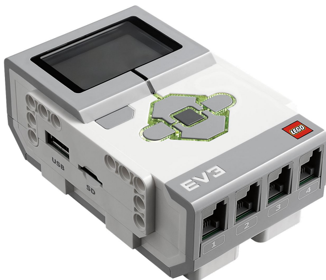
Figura 3.8 – CLP (ou intelligent brick ) do kit LEGO Mindstorms EV3 ® . (Fonte: https://shop.lego.com/en-US/product/EV3-Intelligent-Brick-45500 . Acessado em 28 de Dezembro de 2018)
