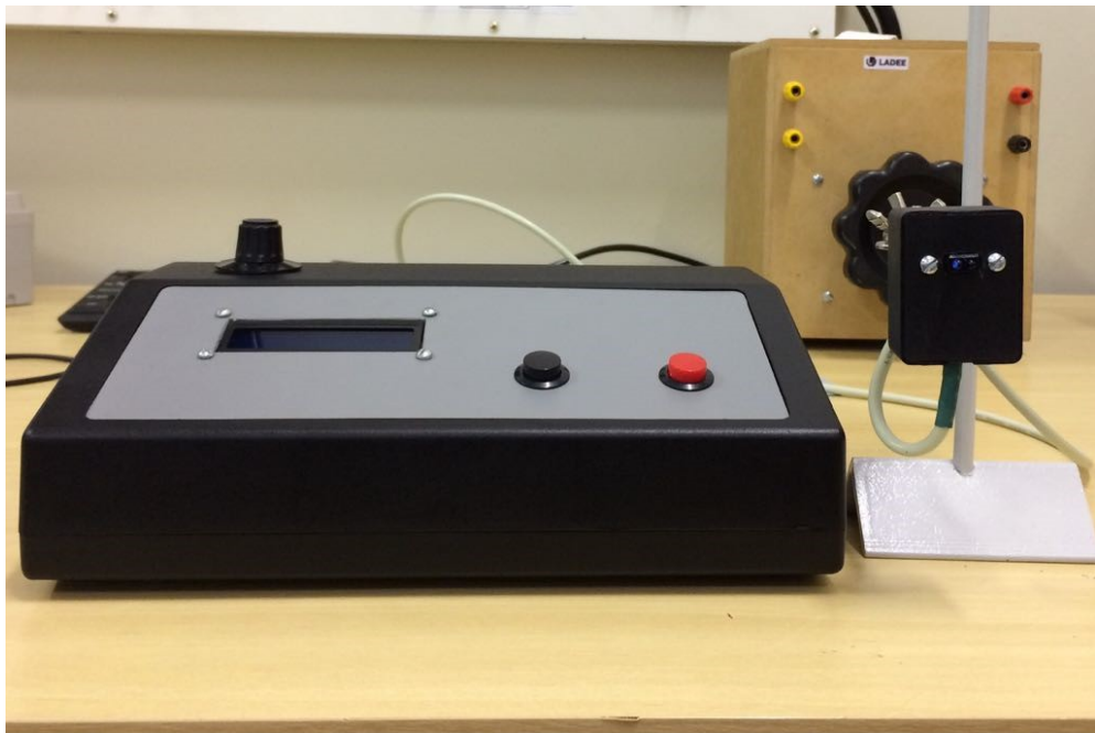
Figura 12 - Tacômetro digital com memória de massa
