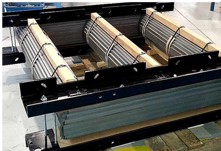
Figura 2 - Núcleo magnético de aço silício
