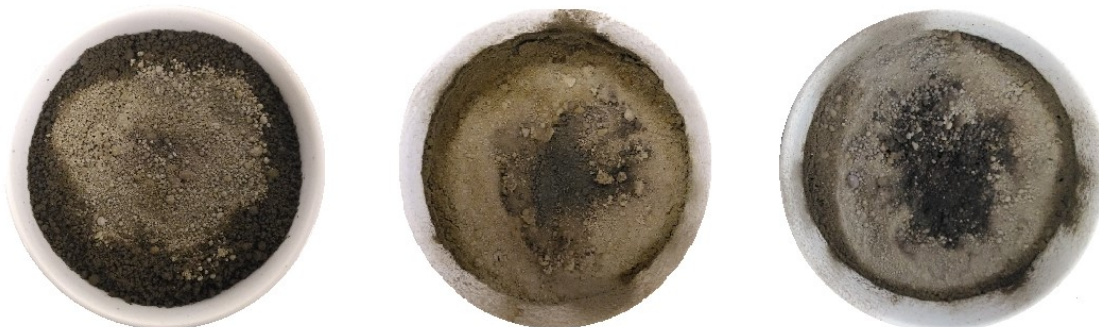
Figura 4.4: Hotspots observados em experimentos de secagem.
