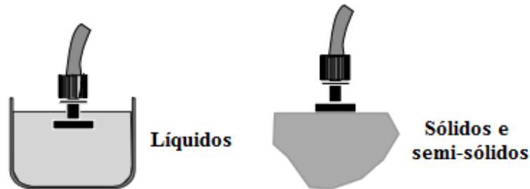
Figura 3.6: Posição da sonda de acordo com o estado físico da amostra. Fonte: adaptado de Keysight Technologies (2017).
