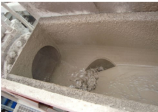
Figura 2.5: Fluido de perfuração sintético à base de n-parafina que retorna do poço sendo perfurado. Fonte: Pereira, 2013.
