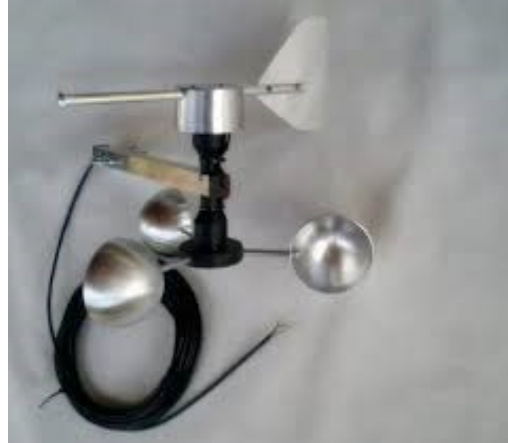
Figura 07 – Anemômetro e biruta eletrônica
