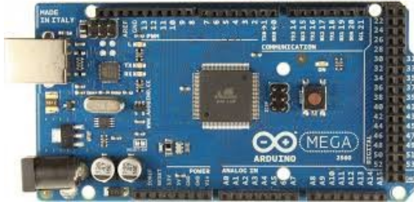
Figura 02 – Placa Arduino Mega 2560 Frente(2018)
