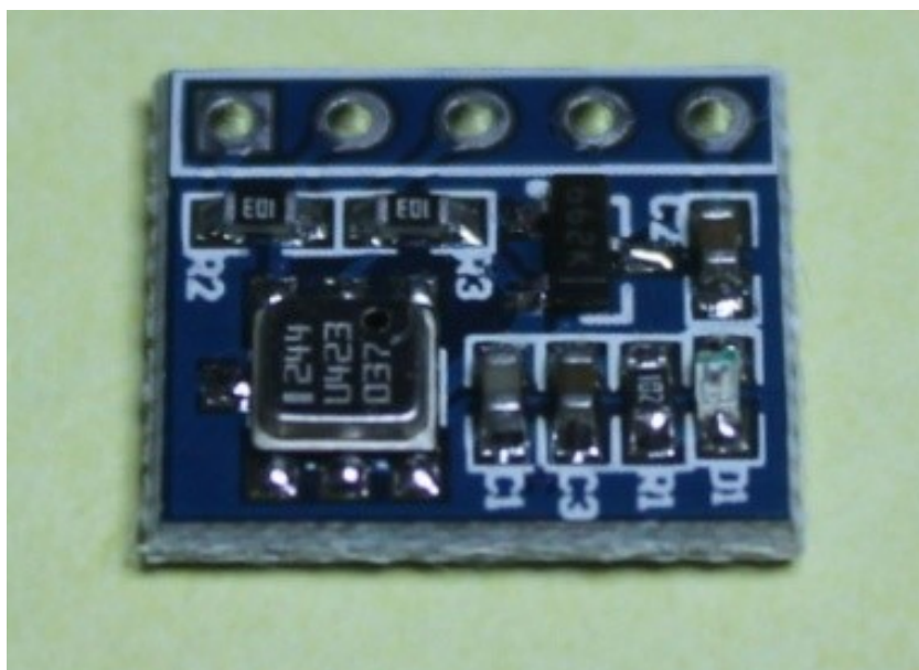
Figura 04 - Sensor de Pressão Barométrica
