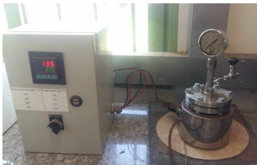
Figura 5 – Reator hidrotermal utilizado nas sínteses dos materiais.
