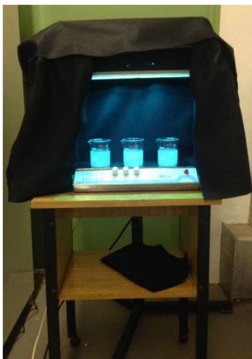
Figura 7 – Aparato utilizado para realização dos ensaios fotocatalíticos.
