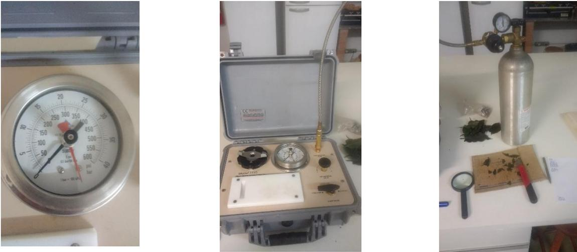
**Figura 2** - Câmara de scholander utilizado para analisar o potencial de água na folha.
