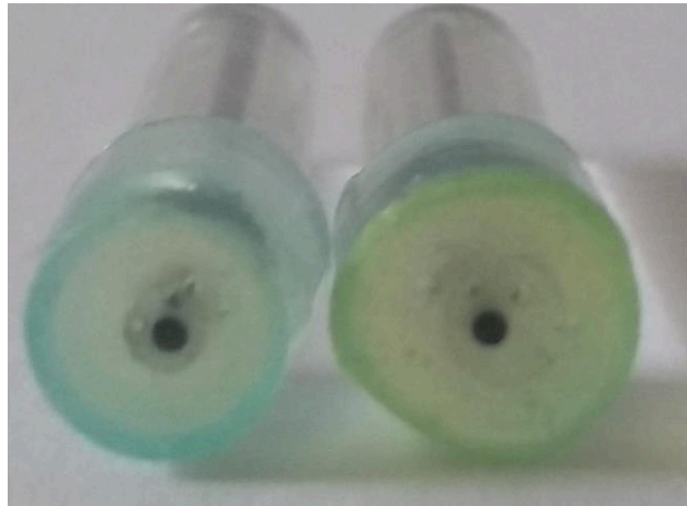
Figura 23 - Imagem da superfície dos eletrodos resinados. À esquerda, biossensor antes e, à direita, biossensor após a detecção do produto 4-nitrofenol.
