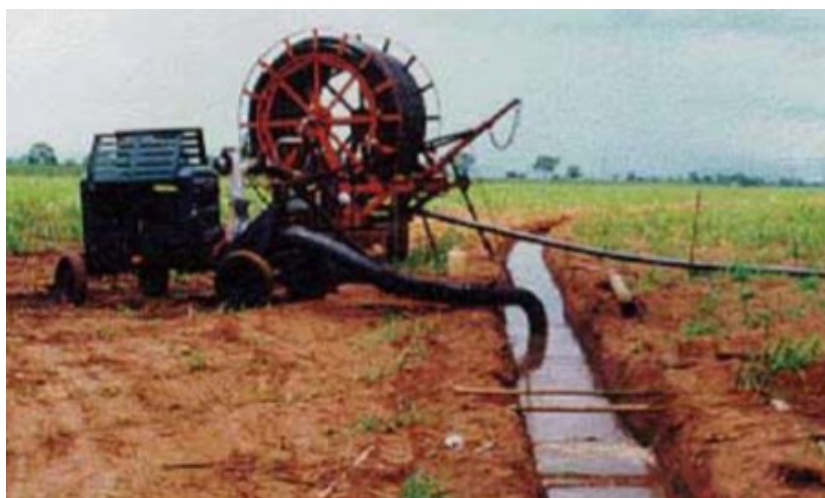
Figura 6 - Carretel enrolador succionando do canal
