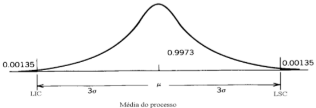
Figura 16 -Gráfico genérico da distribuição normal de um processo centrado com Cp igual a 1.
