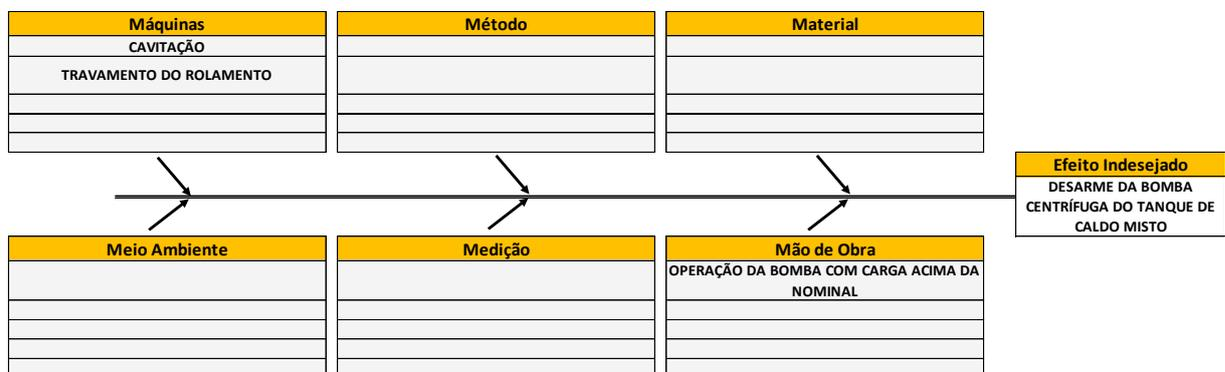
Figura 4.1 - Diagrama de Ishikawa para a bomba centrífuga EQP
