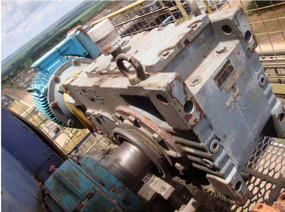
Figura 3.9 - Redutor de engrenagens cônicas compacto SEW série MC
