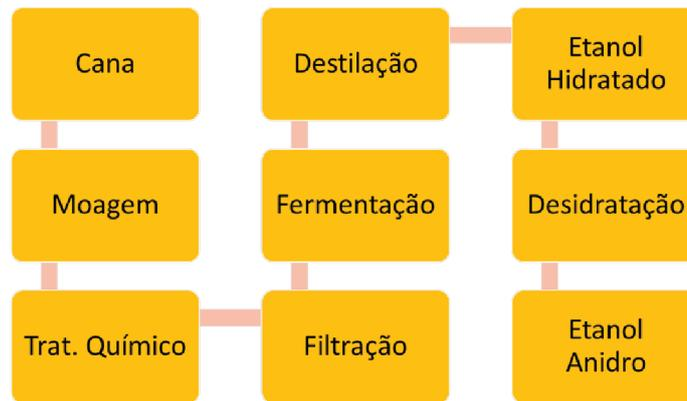
Figura 2.4 - Fluxograma simplificado do processo de produção de etanol 1G
