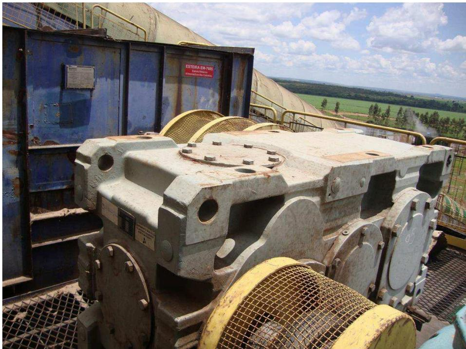
Figura 3.10 - Redutor helicoidal robusto SEW série X
