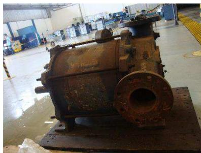
Figura 3.7 - Bomba de vácuo NASH linha Vectra GL
