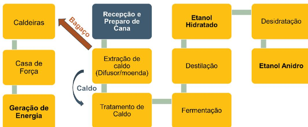
Figura 3.2 – Fluxograma simplificado dos processos de produção de etanol e cogeração de energia
