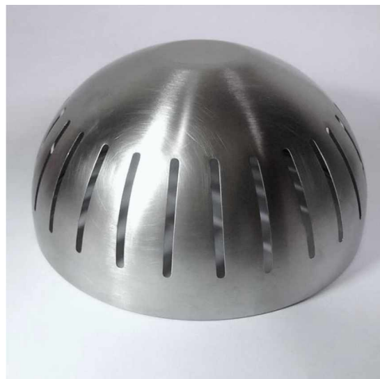
Figura 32. Cúpula limpa com acetona
