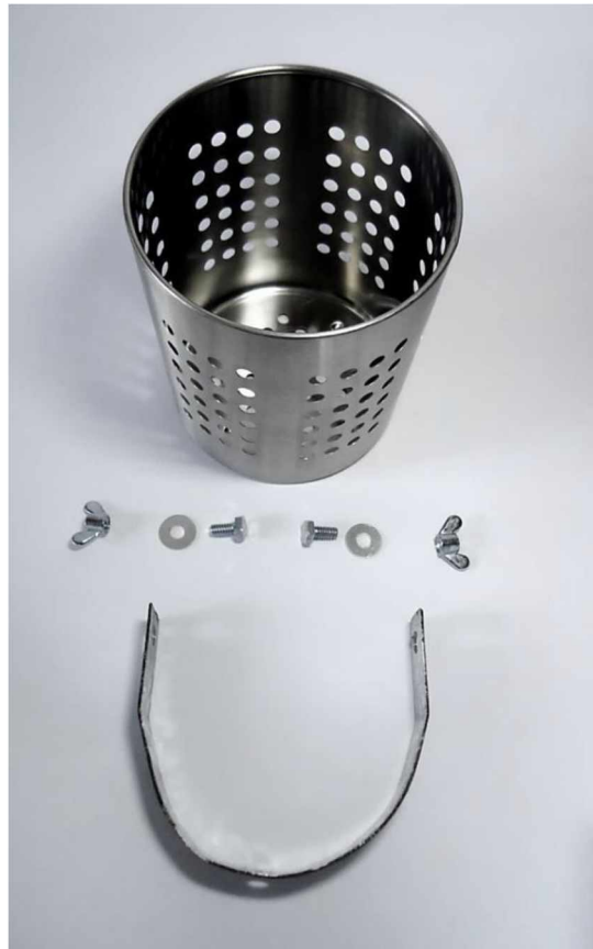
Figura 39: Montagem dos parafusos, cúpula e articulação .
