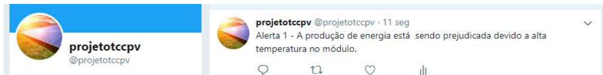
Figura 41– Notificações de falha via Twitter de alta temperatura.
