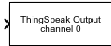
Figura 21 – Bloco utilizado para realizar a comunicação entre MATLAB® e ThingSpeak
